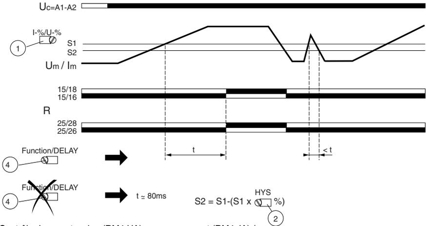
Contrôle de sous-tension (RM4 UA) ou sous-courant (RM4 JA) /
