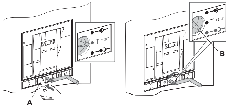
Figura 20 – Extracción del interruptor en la posición de desconectado
