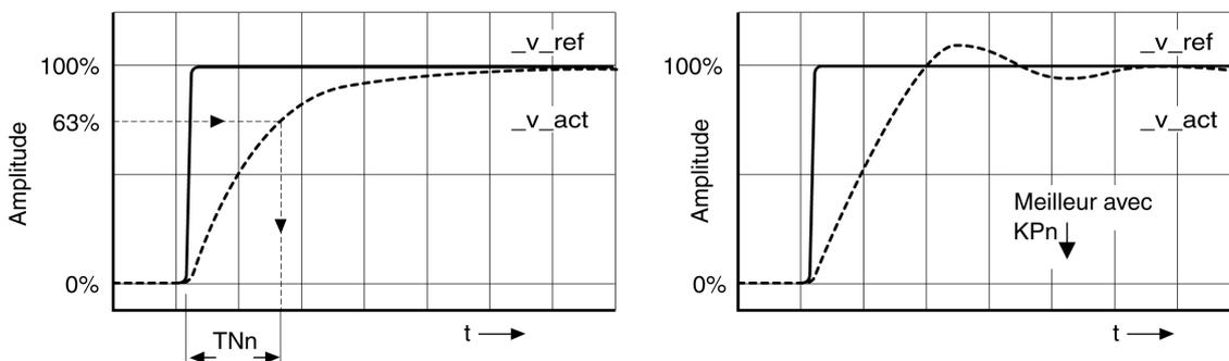
Pour les systèmes d'entraînement pour lesquels des mouvements vibratoires apparaissent avant d'atteindre l'amortissement apériodique, le gain P "KPn" doit être réduit jusqu'à ce qu'aucun mouvement vibratoire ne soit plus perceptible. Ce cas de figure apparaît souvent pour des axes linéaires avec entraînement par courroie crantée.
