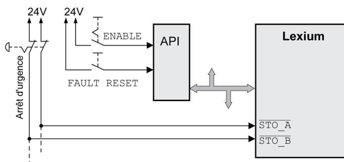
Dans cet exemple, l'activation de l'ARRÊT D'URGENCE entraîne un arrêt de catégorie 0.
