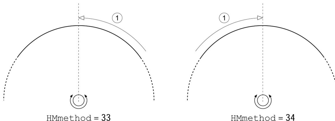
1 Déplacement sur l'impulsion d'indexation à la vitesse  $HMv_{out}$
