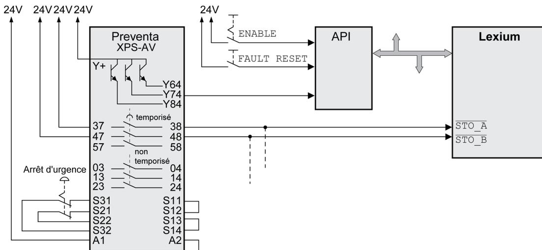
Dans cet exemple, l'activation de l'ARRÊT D'URGENCE entraîne un arrêt de catégorie 1.
