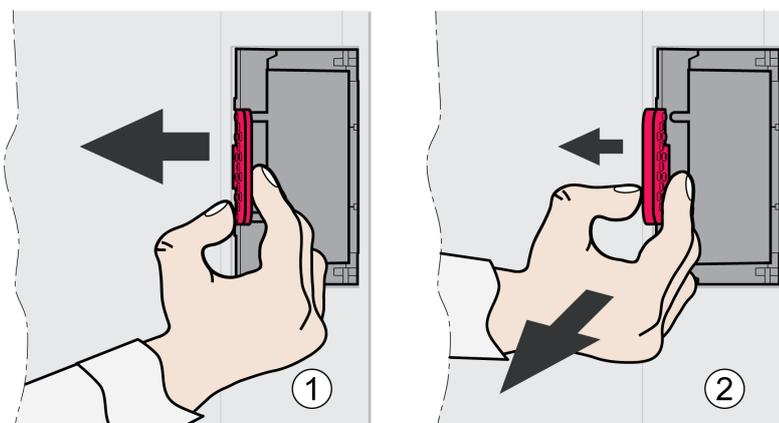
Avant l'insertion ou le retrait d'un module, couper la tension de l'appareil (alimentation de l'étage de puissance et alimentation de la commande 24 VCC désactivées).
