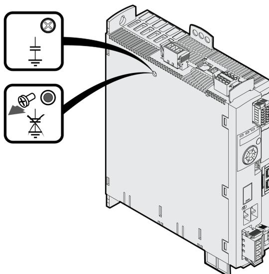
Les condensateurs en Y se désactivent en retirant la vis. Conservez cette vis pour réactiver les condensateurs en Y si nécessaire.
