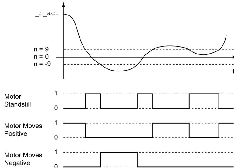
L'état peut être indiqué par les sorties de signal. Pour pouvoir indiquer l'état, la fonction de sortie de signaux "Motor Standstill", "Motor Moves Positive" ou "Motor Moves Negative" doit être paramétrée, voir Entrées et sorties de signaux logiques, page 180.
