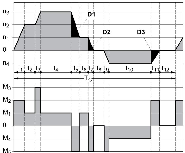
Ces deux courbes caractéristiques sont également utilisées pour le dimensionnement du moteur. Les segments de courbe caractéristique à prendre en compte sont identifiés par  $D_i$  ( $D_1 \dots D_3$ ).
