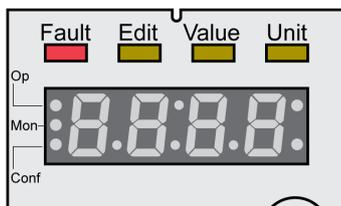
En réglage d'usine, l'afficheur 7 segments indique les états de fonctionnement. Les états de fonctionnement sont décrits à la section États de fonctionnement, page 214.
