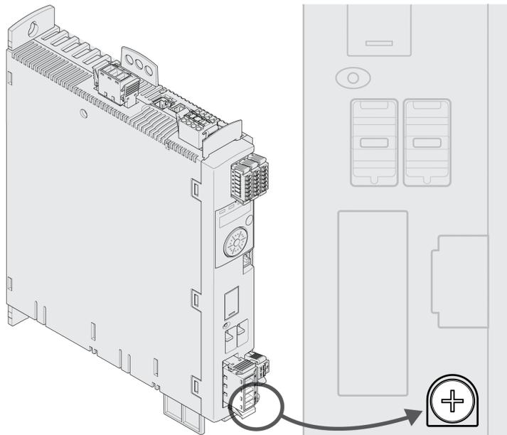
Reliez la prise de terre de l'appareil avec le point de mise à la terre central de l'installation.
