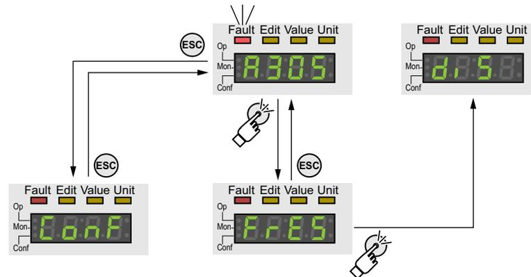
Si l'erreur est de la classe d'erreur 1, une remise à zéro du message d'erreur entraîne une transition de l'état de fonctionnement 7 Quick Stop Active vers l'état de fonctionnement 6 Operation Enabled.
