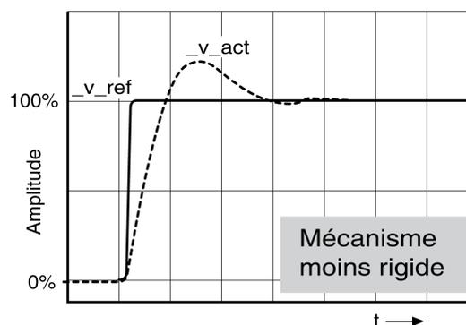
Le régulateur est correctement réglé lorsque la réponse à un échelon correspond environ au tracé du signal représenté. Les éléments suivants sont caractéristiques d'un comportement de régulation correct :
