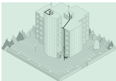
Fig. 6.3. Pararrayos sobre un edificio.
