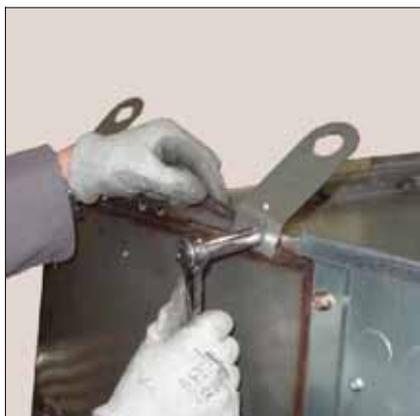
J Lorsque le tableau est installé, il est possible de démonter les 4 pattes de levage (2 clés de 13).
