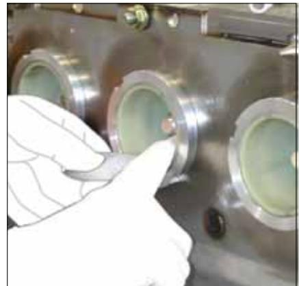
J Avec le gant (3), enduire l'intérieur des douilles d'une fine couche de graisse (4).
