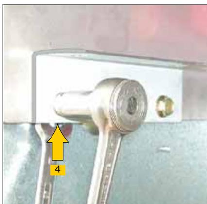
J 4. Glisser un écrou cranté entre la platine et la paroi.
