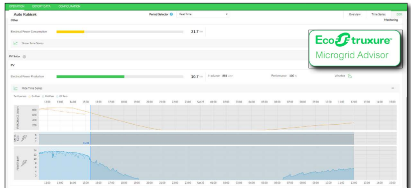
EcoStruxure Microgrid Advisor předpovídá budoucí osvit a výkon FVE.
