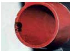
Indicios de carbón en boquillas de disyuntores VMX
