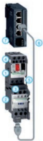
Classiquement, le disjoncteur-moteur & le contacteur, 2 produits différents mais complémentaires, peuvent être combinés à l'aide d'un bloc d'association. Lorsqu'il s'agit d'automatiser le fonctionnement du moteur à l'aide d'un automate programmable, un bloc de contacts auxiliaires est ajouté, et différents signaux sont câblés entre le contrôleur et le départ-moteur :
