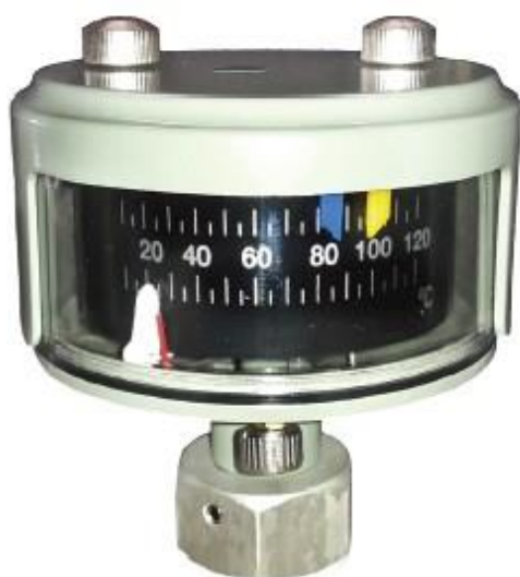
Obr. 13: Typický vzhled teploměru v teploměrovém pouzdra.
