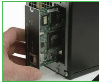
APC的附加卡可用于UPS的智能插槽内来监视电力情况，RT大于等于5KVA的产品随机赠送网络管理卡。
