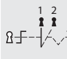
Styki przełącznika 2-pozycyjnego ryglującego z kluczem wysuwającym w obu pozycjach, typu N/O
