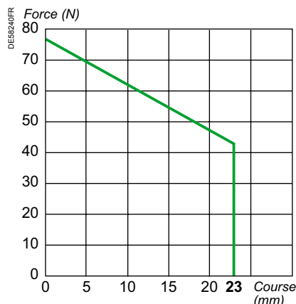
Figure 2 : ce graphique donne la valeur de la force délivrée par le percuteur suivant la longueur de sa course.
