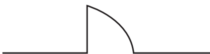
Fig. F72: Símbolo normalizado utilizado en algunos países para indicar que el dispositivo está a prueba de un funcionamiento inadecuado debido a corrientes transitorias.
