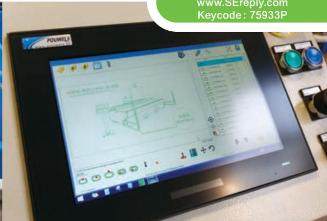
Objectif : charger le plan d'usinage dans l'interface écran HMI et démarrer l'usinage après une simple configuration de l'outil d'usinage (type, diamètre, profondeur). Pour le client final, le bénéfice de ce concept est de permettre une large panoplie d'usinages à partir de composants traditionnels (PLC, écran tactile d'exploitation, servos drives notamment) et à un coup raisonnable.
