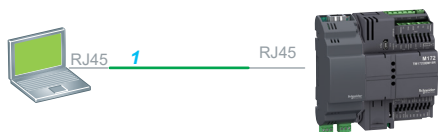
Programmation à distance via le port USB sur le module de communication TM171AETH + contrôleur logique Performance M172
